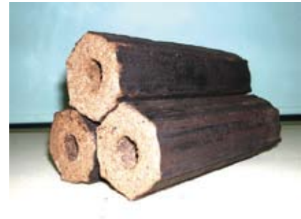
EFB Fibre + Sawdust Briquettes (40:60)
